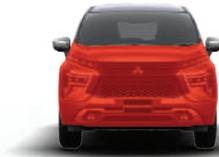
Meminimalisir dampak kecelakaan pada pejalan kaki melalui built impact-absorbing yang terdapat pada material kap mesin dan bumper.
